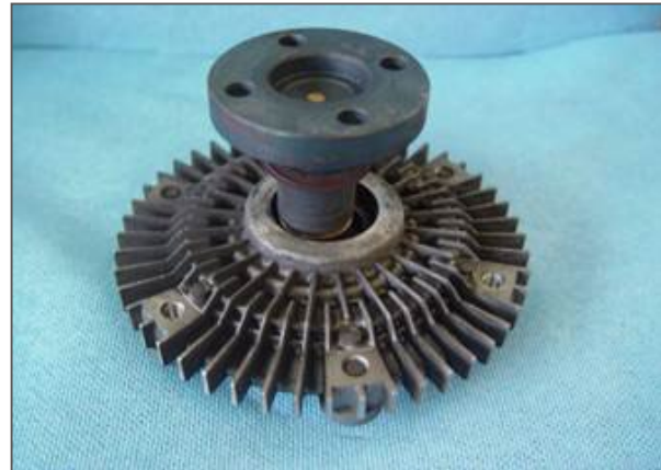
Rodamiento del Fan Clutch bloqueado → rotura
